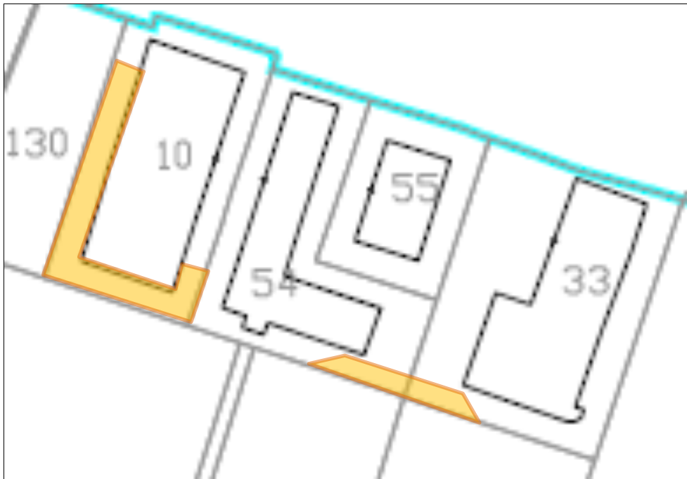
Figura 2: modello con evidenziate le aree contaminate con terre di fonderia
